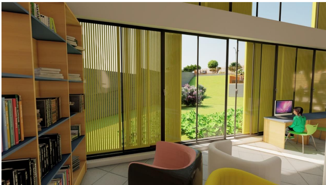
Figura 110 – Brise soleil metálica na vertical
